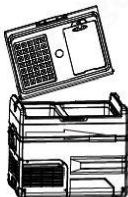
Umieść trzpień zawiasu w otworze z jednej strony
