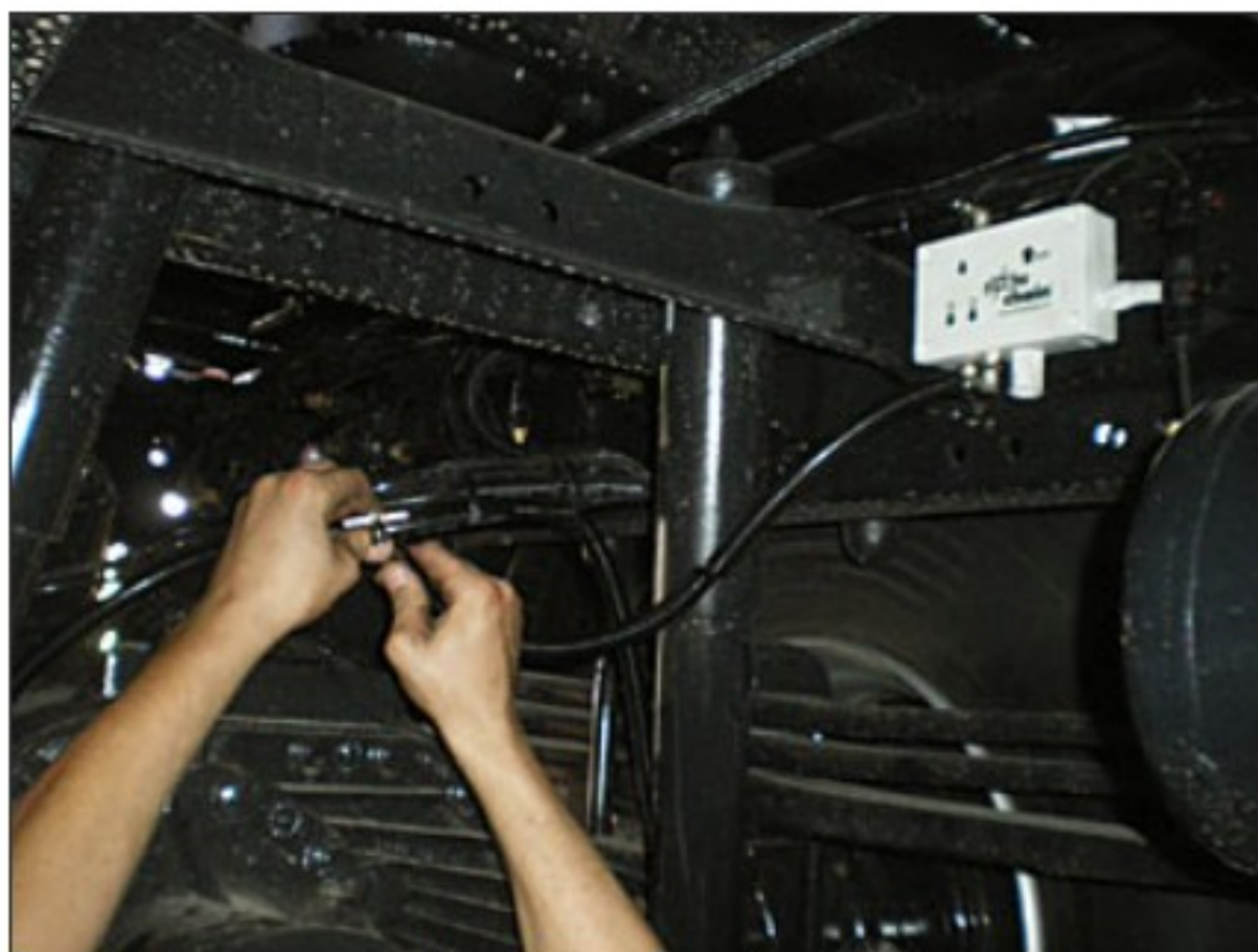
T-kusy rozvádějí vzduch k pohonným jednotkám
