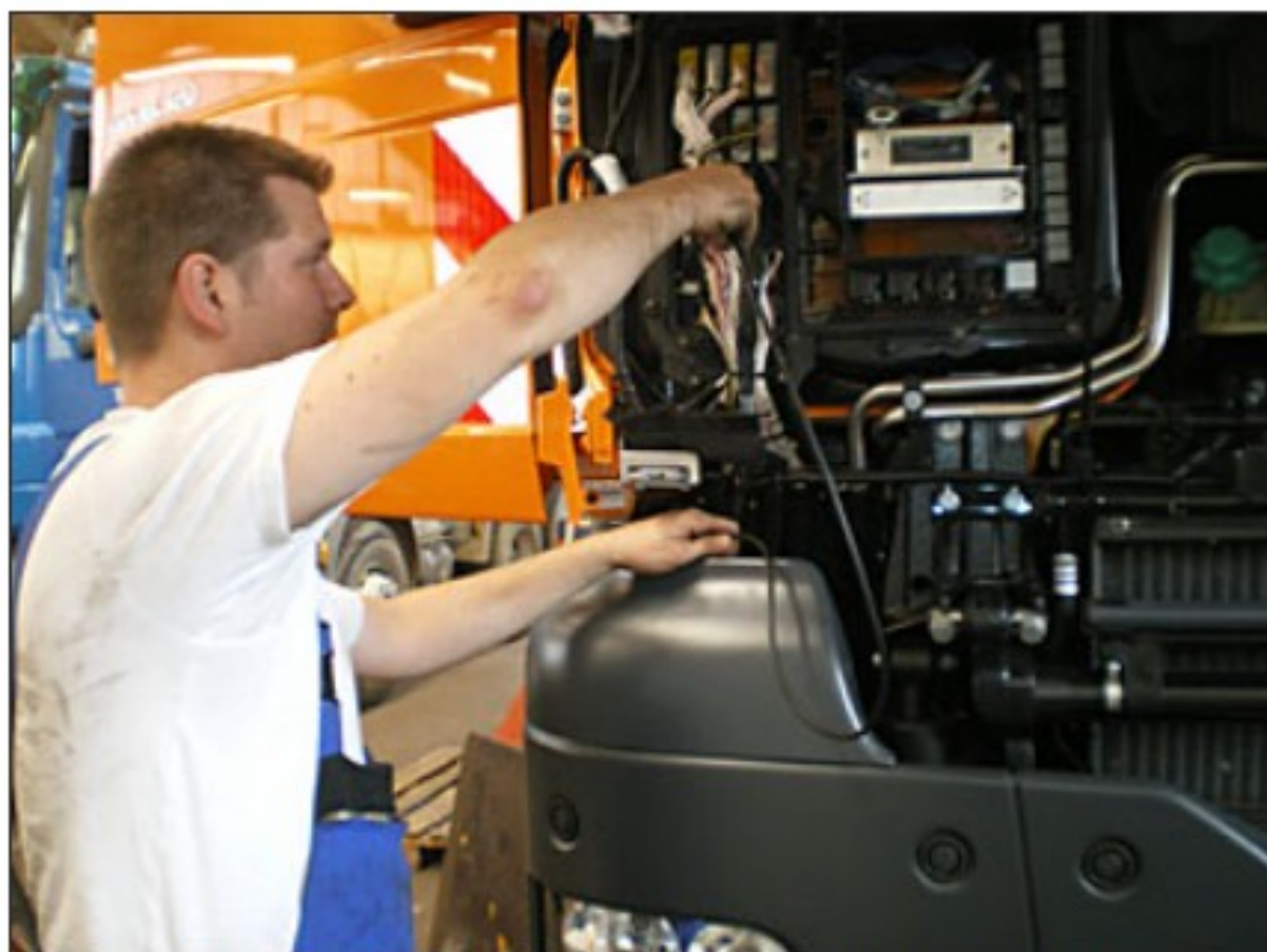
Přístup do interiéru je přes pojistkovou skříň
